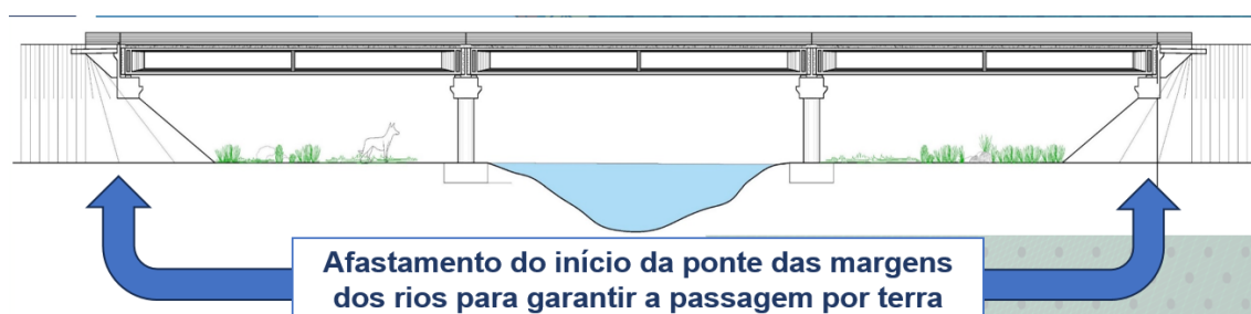
Figura 12. Esquema desenhado pelo DNIT para preservar os cursos d'água – Fonte: Ministério dos Transportes
